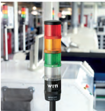
Jederzeit erweiterbar: mit zusätz- lichen „WIN slaves“ können bis zu 50 Maschinen in das Netzwerk integriert werden
