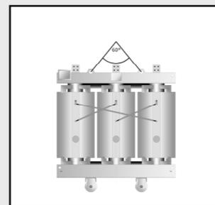
Fig. 9 Movimentazione con carro-ponte
