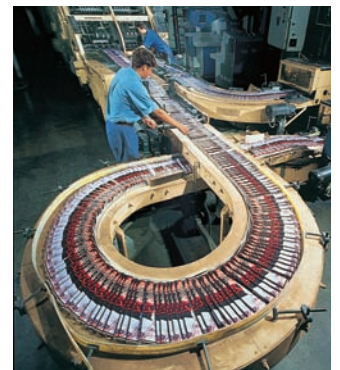
▼ Zeitschriften werden mit dem Multifunktionsensor DMH gezählt
