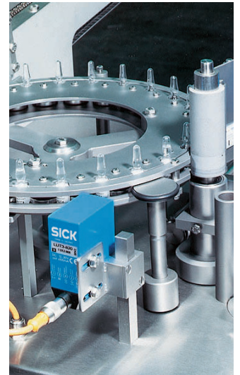
▲ Anwesenheitskontrolle von Etiketten in der Pharmaindustrie mit Lumineszenztaster
