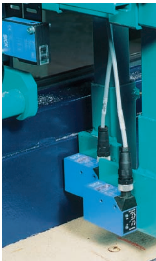
▲ Markierungen auf Brettern werden mit Lumineszenztastern erkannt. Ein Sägevorgang wird ausgelöst.
