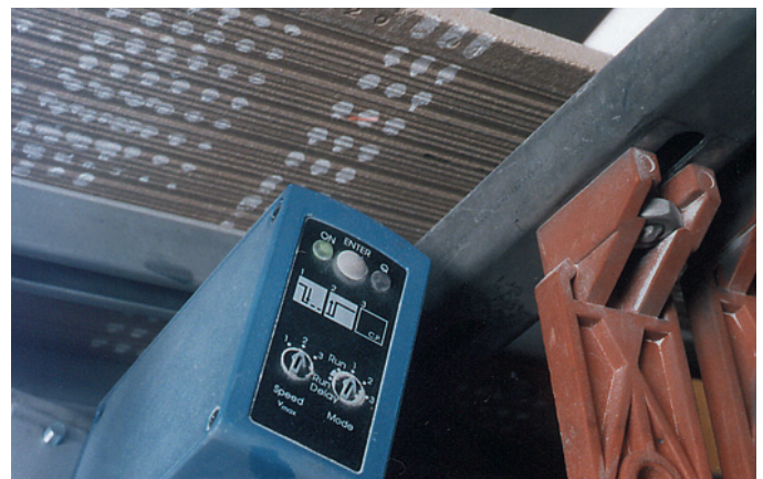
▲ Fliesen werden auf korrekte Lage geprüft
