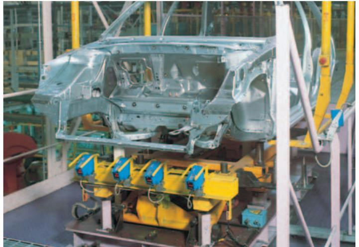
▲ Prüfung/Qualitätskontrolle mit Entfernungsmessgerät DME zur Erkennung von Bohrlöchern.
