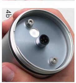
**ACHTUNG:** Nach dem Batteriewechsel muss der DL mit dem Auslesegerät neu konfiguriert werden. Achten Sie darauf, dass weder Schmutz noch Feuchtigkeit in das Gerät gelangt. Nicht mit metallenen Gegenständen im Gerät hantern! Entfernen Sie den schwarzen Schraubverschluss. Heben Sie das Display (1a) bzw. die Steckerplatte (1b), nach lösen der 2 Schrauben, vorsichtig heraus, ohne das Flachbandkabel zu beschädigen.
