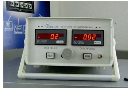
Unità portatile di prova perdite
