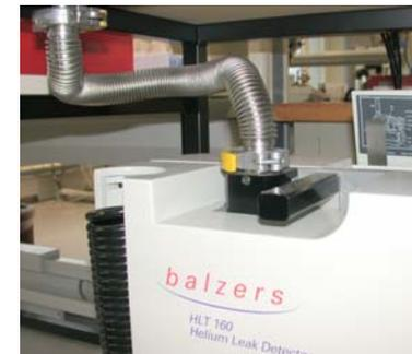
Monitoraggio di pressione in un sistema di prove di tenuta
