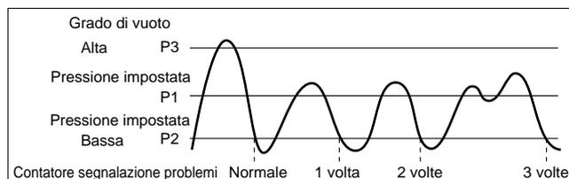
La funzione prevenzione guasti registra quando il sensore si spegne senza aver raggiunto la pressione di (P3) dopo che è stato acceso (più di P1). L'uscita della funzione prevenzione guasti avviene quando la funzione è continuamente conteggiata con determinati livelli pre-impostati. Il conteggio della funzione riprende quando il sensore è di nuovo ON. (più di P1) e la pressione supera la pressione impostata della funzione prevenzione guasti. (P3). (Esempio di modo comparatore).
