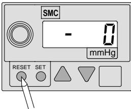
Premendo il pulsante RESET, il sensore si resetterà.
