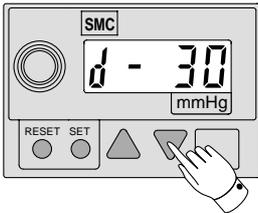
Per visualizzare il valore più basso, (valore più basso del vuoto) premere il pulsante DOWN ▼ durante la normale operazione. Il display LCD visualizza "d". Per tornare all'operazione normale, premere il pulsante DOWN ▼ nuovamente.
