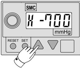
Per visualizzare il picco più alto, (più alto valore di vuoto) premere il pulsante UP ▲ durante la normale operazione. Il display LCD visualizza "H". Per tornare all'operazione normale, premere il pulsante UP ▲ nuovamente.
