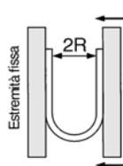
Alla temperatura di 20°C, piegare il tubo a "U". Fissare un'estremità e chiudere gradualmente la "U". Misurare 2R quando il tubo si rompe o viene schiacciato.
