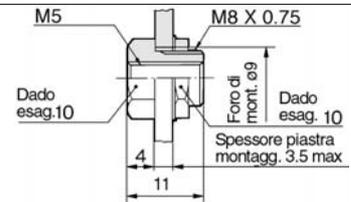
Per spessore della piastra di 3.5 ÷ 6mm, usare dado M8 X 0.75 e poi avvitare.
