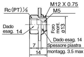
Per spessore della piastra di 3.5 ÷ 6mm, usare un dado M12 X 0.75 e poi avvitare
