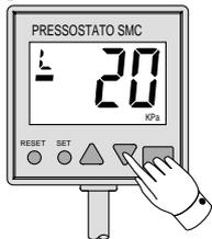
Per visualizzare il valore più basso, (valore più basso del vuoto), premere il bottone DOWN durante l'operazione normale. Il LCD visualizza "L". Per ritornare all'operazione normale, premere il bottone DOWN nuovamente.
