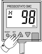
Per visualizzare il picco di pressione più alto, (più alto valore di vuoto), premere il bottone UP durante l'operazione normale. Il LCD visualizza "H". Per ritornare all'operazione normale, premere il bottone UP nuovamente.
