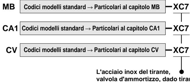
La matière des pièces standard a été remplacée par l'acier inox afin que le vérin puisse être utilisé dans des milieux corrosifs.
