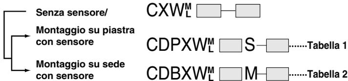
② Per cambiare, la serie CXW<sup>M</sup>, dal modello su piastra con sensore al modello su sede con sensore o viceversa, ordinare riferendosi alle tabelle 1 e 2.
