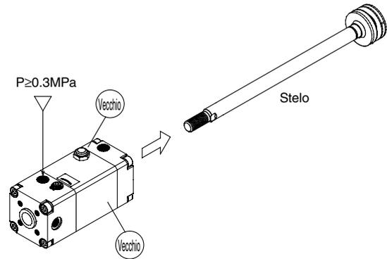
4) Allo stesso modo, alimentare, con aria compressa  $\geq 0.3\text{MPa}$  l'attacco di rilascio bloccaggio della nuova unità e sostituire lo stelo con lo stelo di ricambio.
