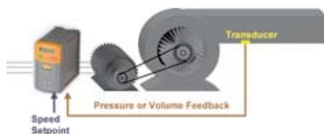
**Controllo PID:** controllo variabili quali pressione, flusso, temperatura ed altre tramite il monitoraggio del trasduttore di retroazione.
