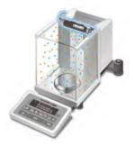
PESATURA DI FARMACI IN POLVERE GRAZIE ALLO IONIZZATORE (INDICATO CON LA FRECCIA)
