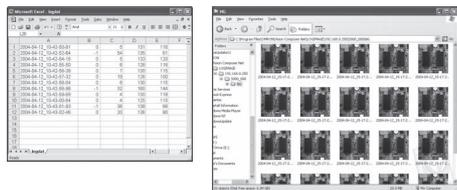
I dati memorizzati nell'unità di controllo possono essere visualizzati in elenchi.
