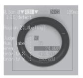
Rilevamento accurato delle deformità delle parti interne in gomma.
