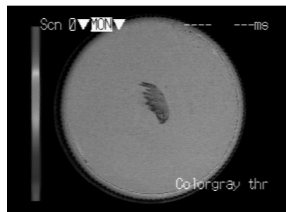
Immagine con colori in scala di grigio I difetti a malapena visibili nell'immagine originale vengono evidenziati chiaramente.
