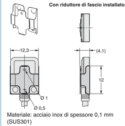
Unità di regolazione della sensibilità (per i modelli a sbarramento E3T-ST1□)
