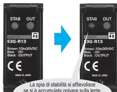
La spia di stabilità si affievolisce se si è accumulata polvere sulla lente o la regolazione dell'asse ottico non è appropriata.
