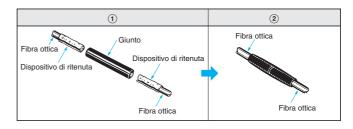
Quando si procede alla giunzione, la distanza tra le fibre deve essere ridotta al minimo possibile. Quando si uniscono le due fibre, la distanza di rilevamento risulterà ridotta di circa il 25%.
