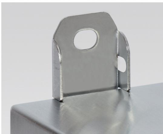
Realizzati in aisi 316L, con le stesse caratteristiche dei fissaggi SP025 ma rispetto a questi ultimi sono dotati di una base di appoggio maggiore che permette di puntarli al contenitore senza usare viti di fissaggio. Sono predisposti per il fissaggio di un cavo di messa a terra.
