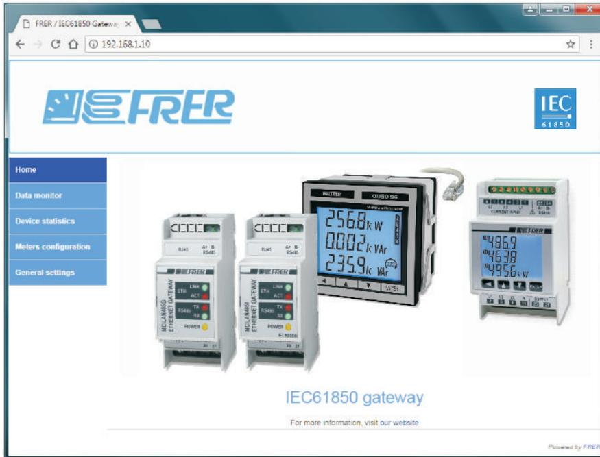
Ogni gateway IEC61850 è dotato di un Web-server di configurazione integrato (accessibile digitando il relativo indirizzo IP sulla barra degli indirizzi di qualsiasi browser Web di propria scelta), utilizzato per configurare alcuni dettagli funzionali del gateway stesso, alcuni comportamenti del protocollo IEC61850, e monitorare, nel processo di messa in servizio, il corretto funzionamento del sistema.
