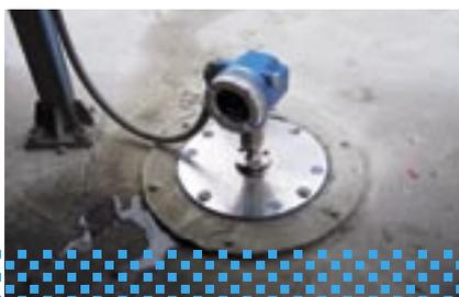
Misura di livello con radar **Micropilot M**
