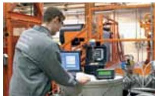
Taratura in loco degli strumenti di temperatura
