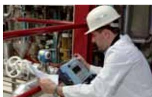
Taratura in loco degli strumenti di pressione
