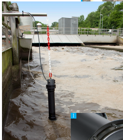
1 Sistema con elettrodo ionoselettivo per la misura continua in loco di ammonio e nitrato.
