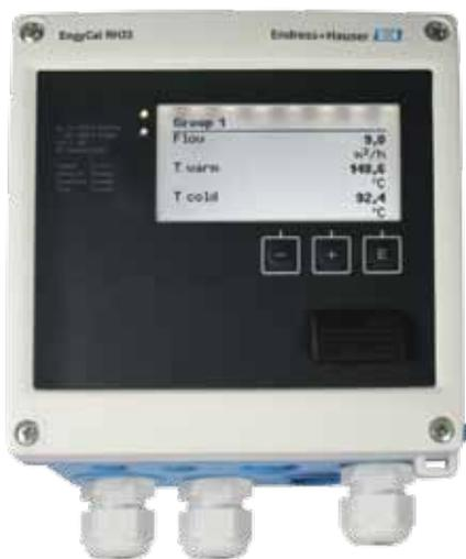
Il computer per il calcolo dell'energia termica misura il flusso di energia nei sistemi di riscaldamento/raffreddamento basandosi sui valori di portata volumetrica e temperatura in ingresso e uscita (differenza termica) da uno scambiatore di calore.
