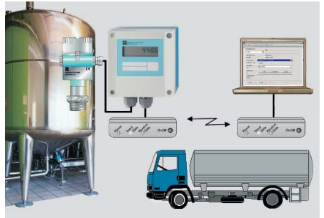
Misura del livello di melassa in un serbatoio specifico del cliente presso il fornitore. Minilog B memorizza i consumi del cliente e informa il fornitore sull'attuale livello del serbatoio di stoccaggio. I dati sono raccolti sul punto di rifornimento centrale e sono disponibili per pianificare consegne puntuali.
