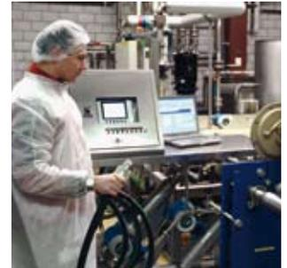
Se è necessaria la tracciabilità della verifica della misura di portata viene utilizzato un mobile rig per eseguire la taratura on-site.
