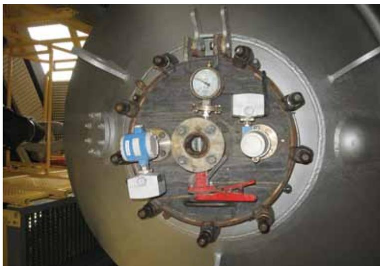
Tamburo a depressione per il processo di essiccazione: installazione wireless per componenti in movimento dell'impianto
