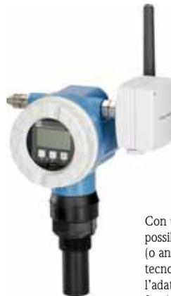
Con un adattatore WirelessHART è possibile aggiornare istantaneamente HART (o anche semplicemente 4...20 mA) alla tecnologia WirelessHART. Se necessario, l'adattatore WirelessHART può anche fornire l'alimentazione tramite la batteria incorporata.
