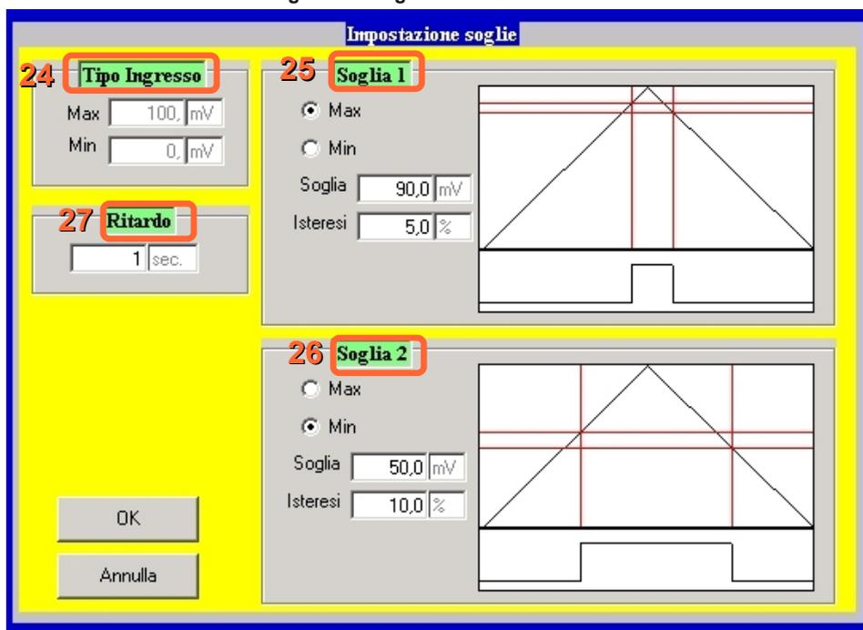
Tramite questa interfaccia è possibile impostare le soglie di allarme solo nei dispositivi dove è prevista questa funzione ( ad esempio DAT 4235 IS); nei dispositivi dove questa funzione non è prevista, i campi Soglie (18 – figura 1 e 28 – figura 2 ) non sono visibili.
