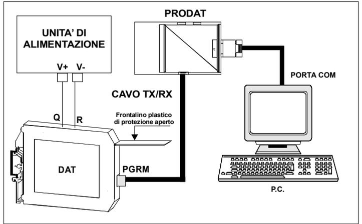
Attenzione: durante tutta la procedura il dispositivo deve essere sempre alimentato ed il cavo di collegamento non deve essere scollegato. Per informazioni dettagliate sul funzionamento del programma di configurazione, fare riferimento al relativo manuale operativo.
