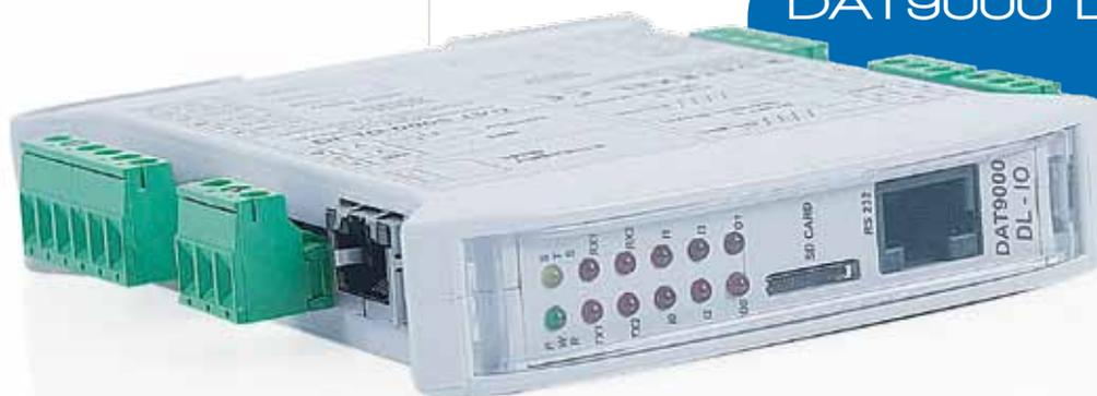
Unità intelligente, dotata di n°1 interfaccia seriale RS-485 Modbus RTU Master, n°1 interfaccia seriale RS-485 Modbus RTU Slave, n°1 interfaccia RS-232, n°1 interfaccia Ethernet 10 Base-T Modbus TCP.
