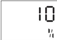
Sobald durch Drücken der - der -Taste die Stellgröße verändert wird, schaltet die Anzeige automatisch auf den Wert der Stellgröße um, nach Loslassen der Taste wird wieder der Istwert angezeigt.
