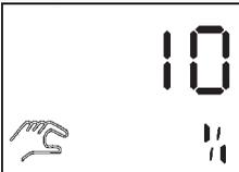
Sobald durch Drücken der - oder -Taste die Stellgröße verändert wird, schaltet die Anzeige automatisch auf den Wert der Stellgröße um, nach Loslassen der Taste wird wieder der Istwert angezeigt.
