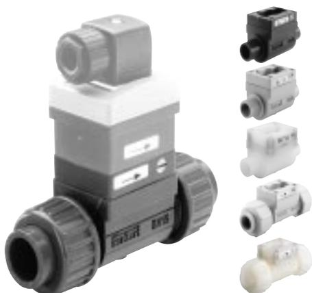
Il raccordo S010 ha una singola leva per intercettare il flusso. Questo evita ogni rischio di trafilamento ed è ciò che Bürkert definisce tecnologia a quarto di giro Inline. Il punto di commutazione viene trasmesso senza contatti da un campo magnetico. L'unità elettronica SE10 può essere montata o rimossa senza aprire la tubazione del processo. Il punto di commutazione può essere impostato nell'unità SE10.
