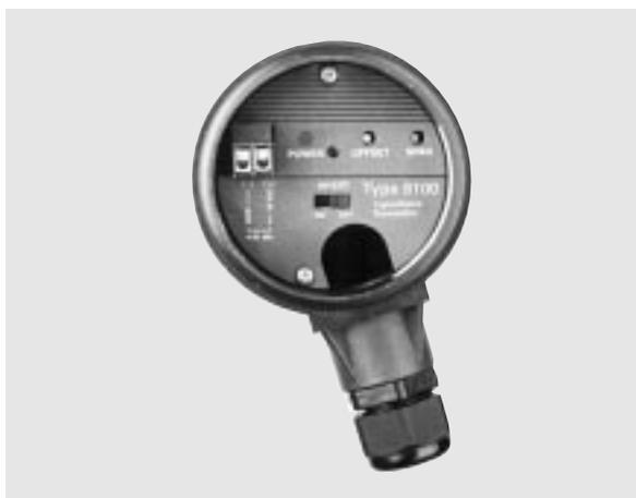
La piastra frontale del trasmettitore comprende un LED per l'indicazione dell'alimentazione, i potenziometri di regolazione per Offset e Span, un interruttore per l'inversione dell'uscita ed un morsetto estraibile.
