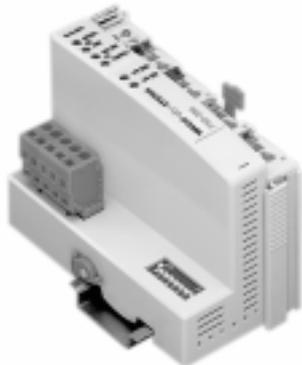
Der Feldbus-Koppler verbindet das WAGO-I/O-System als Slave mit dem DeviceNet™. Er erkennt alle gesteckten analogen und digitalen I/O-Klemmen und erstellt daraus ein lokales Prozeßabbild. Das Prozeßabbild wird in einen Eingangs- und Ausgangsbereich unterteilt. Die Prozeßdaten können über DeviceNet™ eingelesen und in einer Steuerung weiterverarbeitet werden. Die Prozeßausgangsdaten werden über DeviceNet™ ausgegeben.
