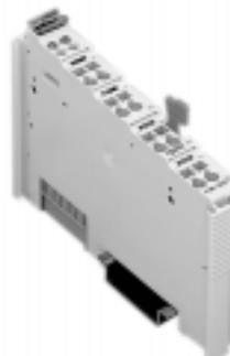
Die analogen Ausgangsklemmen geben Normsignale von 0 bis 10 V ab. Diese Signale werden galvanisch getrennt mit 12 Bit Auflösung an die Systemebene ausgegeben. Zur Spannungsversorgung dient die interne Systemspannung. Die Ausgangskanäle der Module haben identisches Bezugspotential.
