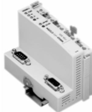
Der Feldbus-Koppler verbindet das WAGO-I/O-System als Slave mit dem INTERBUS. Er erkennt alle gesteckten analogen und digitalen I/O-Klemmen und erstellt daraus ein lokales Prozeßabbild. Das Prozeßabbild wird in einen Eingangs- und Ausgangsbereich unterteilt. Die Prozeßdaten können über den INTERBUS eingelesen und in einer Steuerung weiterverarbeitet werden. Die Prozeßausgangsdaten werden über den INTERBUS ausgegeben.
