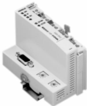
Der Feldbus-Koppler verbindet das WAGO-I/O-System als Slave mit dem PROFIBUS. Er erkennt alle gesteckten analogen und digitalen I/O-Klemmen und erstellt daraus ein lokales Prozeßabbild. Das Prozeßabbild wird in einen Eingangs- und Ausgangsbereich unterteilt. Die Prozeßdaten können über den PROFIBUS eingelesen und in einer Steuerung weiterverarbeitet werden. Die Prozeßausgangsdaten werden über den PROFIBUS ausgegeben.
