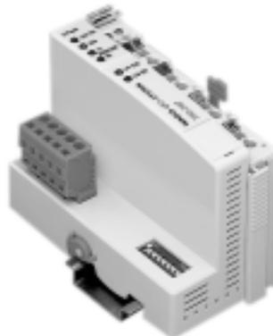
Der Feldbus-Koppler verbindet das WAGO-I/O-System als Slave mit dem CANopen. Die Daten werden mit PDOs und SDOs übertragen. Der Koppler erkennt alle gesteckten analogen und digitalen I/O-Klemmen und erstellt daraus ein lokales Prozeßabbild. Das Prozeßabbild wird in einen Eingangs- und Ausgangsbereich unterteilt. Die Prozeßdaten können über CANopen eingelesen und in einer Steuerung weiterverarbeitet werden. Die Prozeßausgangsdaten werden über CANopen ausgegeben.
