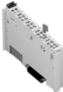
Die digitalen Ausgangsklemmen geben die Steuersignale des Automatisierungsgerätes an die Aktoren weiter. Alle Ausgänge sind kurzschlußfest. Feld- und Systemebene sind galvanisch getrennt. Die 2-Kanal-Klemmen sind in Vierleitertechnik ausgeführt, so daß Aktoren mit PE-Anschluß direkt verdrahtet werden können. Die 4-Kanal-Klemmen sind in Zweileitertechnik ausgeführt. Für induktive Lasten ist eine angepaßte Schutzbeschaltung einzusetzen.
