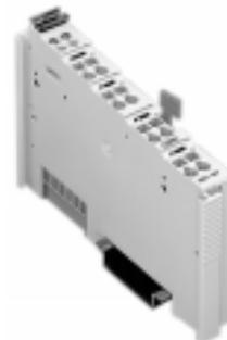
Die analogen Eingangsklemmen verarbeiten das Normsignal 0 – 10 V. mit 12 Bit Auflösung. Dieses Signal wird galvanisch getrennt zur Systemebene übertragen. Als Spannungsversorgung dient die interne Systemspannung.
