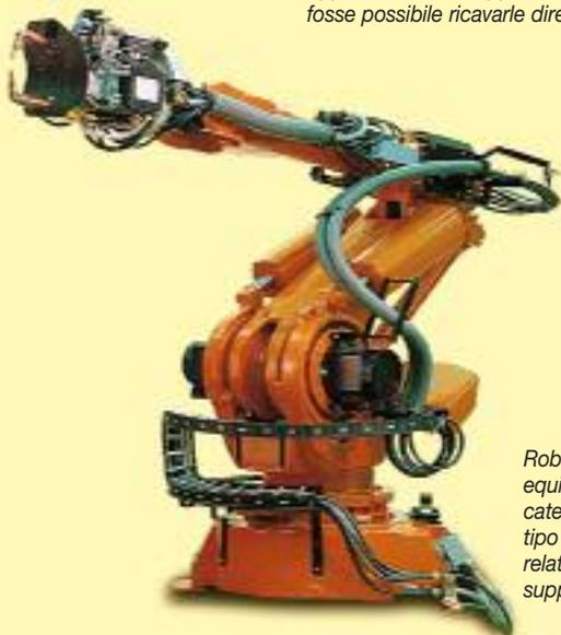
Robot di saldatura equipaggiato con catena in nylon tipo SR510 con relativa culla di supporto.
