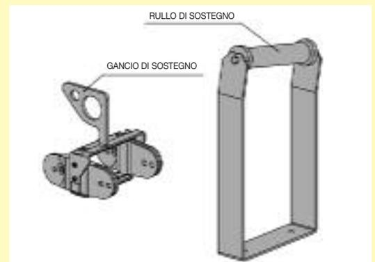
Le catene della serie "Robot" sono autoportanti e non necessitano sostegni sino a rotazioni di 200°. Per applicazioni con rotazioni superiori è necessario utilizzare gli appositi accessori. Al fine di ridurre i problemi d'ingombro che generalmente i supporti creano specialmente sui robot, Brevetti Stendalto ha sviluppato una serie di supporti in grado di risolvere qualsiasi problema.
