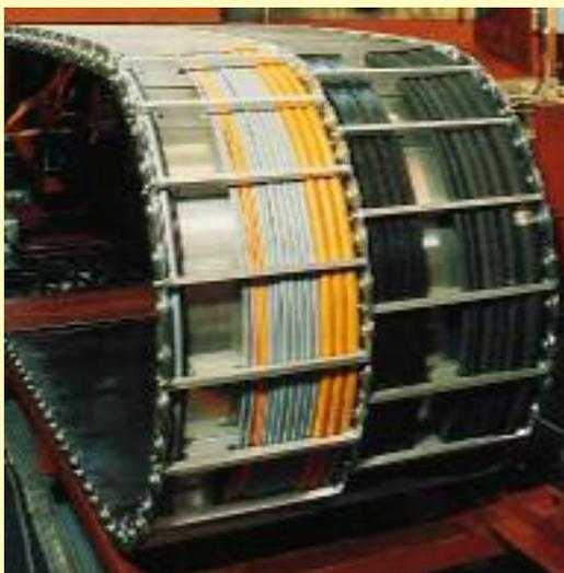
Catena in acciaio tipo BS3000 a banda tripla con suddivisione tra cavi elettrici e tubi oleodinamici.
