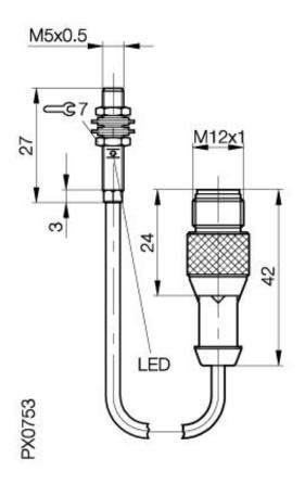
Induktiver Näherungsschalter BES 516-3005-G-E4-C-S 4-00,2 M5x0.5 x 27 **Schließer** Sn=1,5mm bündig einbaubar
