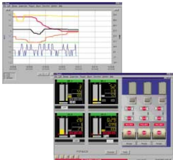
E' l'ambiente software utilizzato per configurare un'applicazione, ed è basato su di un insieme di moduli totalmente integrati, che facilitano la creazione e la modifica del database e dell'interfaccia operatore.
