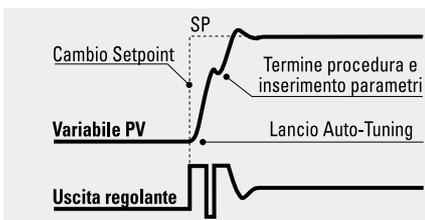
Il metodo **Frequenza naturale**, utilizzato quando al lancio la variabile coincide praticamente con il Setpoint, calcola i parametri ottimali del PID facendo oscillare il processo attorno al valore del Setpoint, ha il vantaggio di una maggior accuratezza nella definizione dei parametri.
