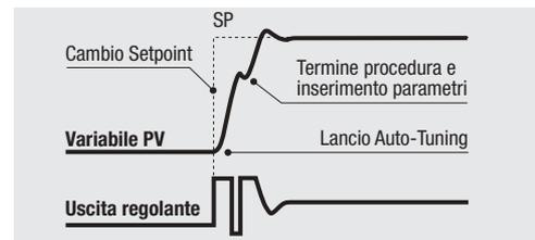
Il metodo **Frequenza naturale**, utilizzato quando al lancio la variabile coincide praticamente con il Setpoint, calcola i parametri ottimali del PID facendo oscillare il processo attorno al valore del Setpoint, ha il vantaggio di una maggior accuratezza nella definizione dei parametri.
