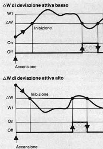
Fig. 3: Caratteristica di uscita dei regolatori a doppia azione. Esempio Caldo-Freddo
